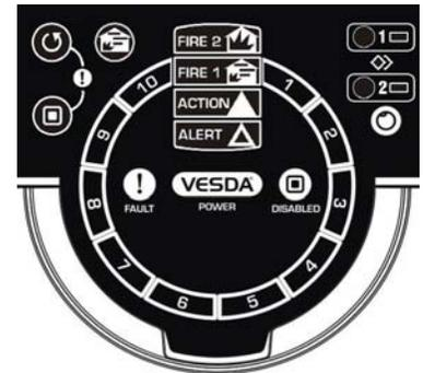
Al abrir la puerta de acceso para mantenimiento, el usuario puede activar las funciones RESTAURAR (🔄), DESACTIVAR (🛑), Prueba de incendio (🔥), AutoLearn (🔍) e Instant Fault Finder (Localizador Instantáneo de Fallas). Cuando se activa la función Instant Fault Finder, la pantalla circular se transforma en un indicador de averías cuyos números corresponden a las averías que se enumeran a continuación.
